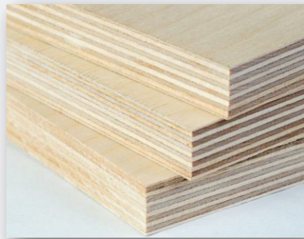
Corte de contrachapado de madera
