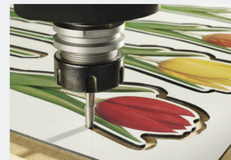
Corte de contorno en composite
