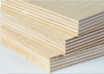
Corte de contrachapado de madera.
